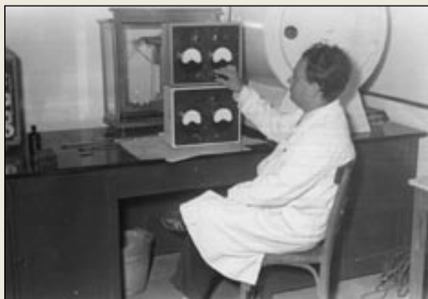
Az első, saját készítésű termisztoros hőmérsék- letmérő 1953-ban
